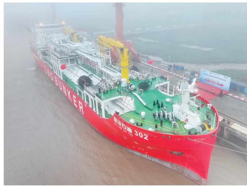
4月28日在中集太平洋海工码头的“海洋石油302”(无人机照片)。当日，由南通中集太平洋海工为中海油建造的12000立方米LNG运输加注船“海洋石油302”在江苏启东海工船舶工业园顺利交付。该加注船总长132.9米，货舱总容量达12000立方米，具有“江海直达”“冰区航行”等性能优势，将为我国家、海域液化天然气船舶提供灵活的加注服务。
